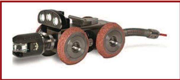
Otras de las aplicaciones importantes es la inspección de cañerías y el traslado de herramientas pesadas y de dimensiones poco manejables. Esto ha hecho que se realicen robots que no produzcan chispas que puedan deflagrar el gas y ocasionen incendios y explosiones. Tiene movimientos simples y rápidos y cumplen con la normativa para áreas clasificadas como eléctricamente peligrosos. Deben responder a normas exigentes.
