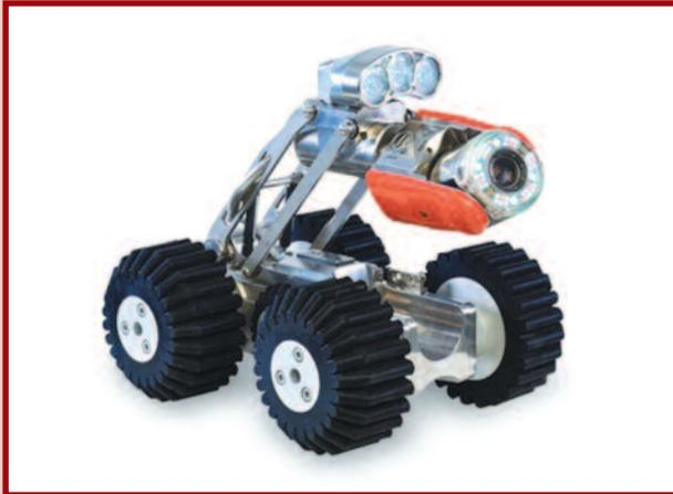
El robot teledirigido para la inspección y mantenimiento Central de Energía CEIT, siendo sus características las siguientes: Desarrollo de hardware electrónico, desarrollo de SW en tiempo real, diseño mecánico para robots ligeros y compactos, teleoperación con posibilidades de retroalimentación de fuerza, inspección ultrasónica, manejo, taladrado y fresado.
