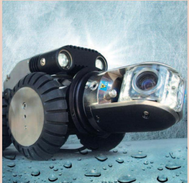
El otro robot para inspección de tuberías, es para detectar rajaduras, obstáculos o corrosión mediante inspección visual en el interior de las cañerías, se emplea una cámara infrarroja y se mueve a través de un sistema neumático controlado remotamente, lo cual le permite avanzar en una cañería vertical.
